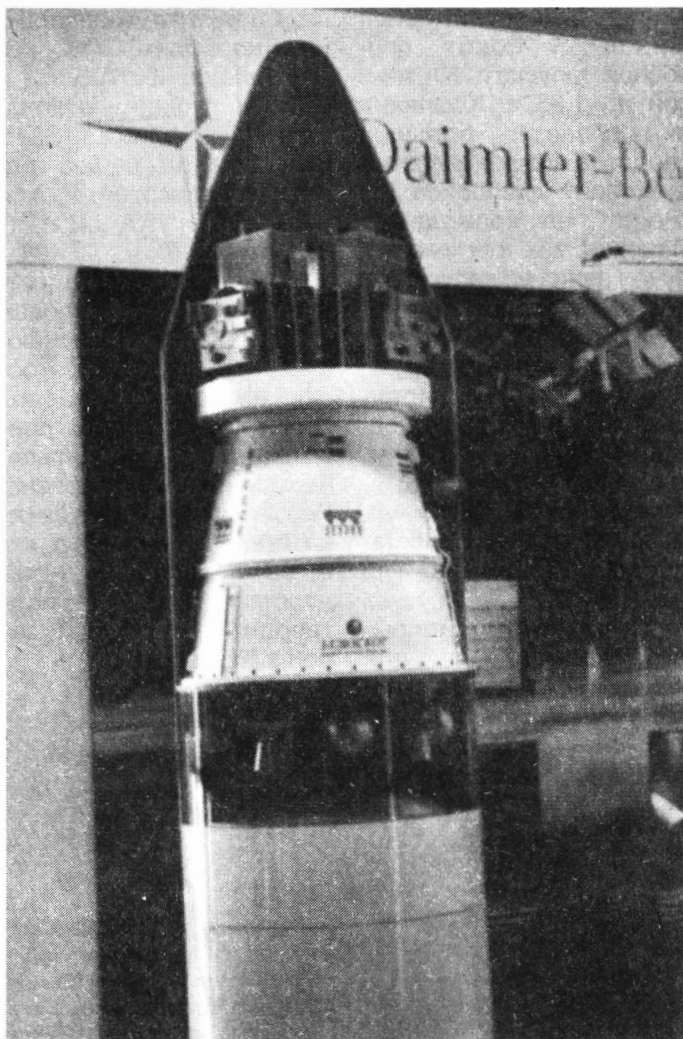
Модель РН "Рокот" с разгонным блоком "Бриз-М" и спутниками на стенде фирмы DASA (Германия)
